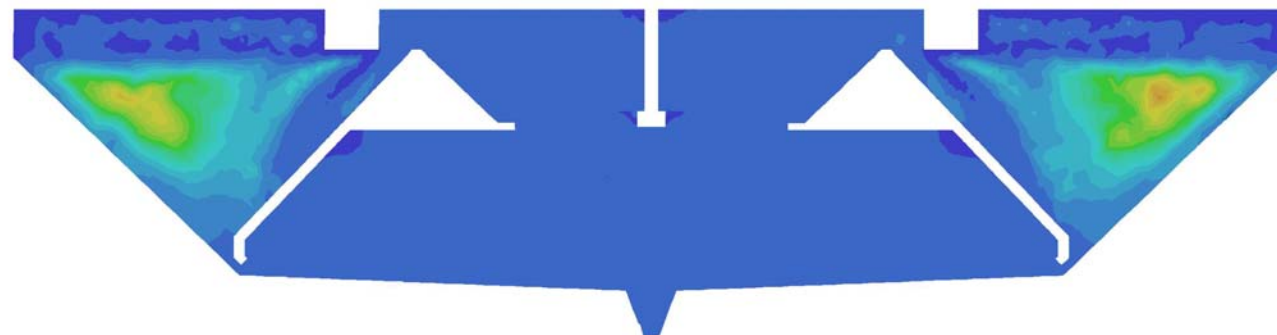
Molekulare Viskosität (rot: 0,02 kg/(ms))
