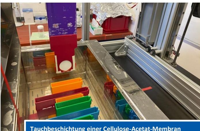
Tauchbeschichtung einer Cellulose-Acetat-Membran (Bild: Hongkang Li)
