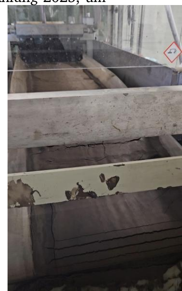
Filterkuchen nach der Filtration in der Pilotanlage im Industriepark Höchst (Bild: I. Sha-
