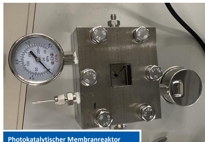
Photokatalytischer Membranreaktor (Bild: Tong Li)
