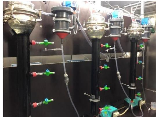
Anaerobe EGSB-Versuchsanlage. (Bild: S. Kale-Fundneider)
