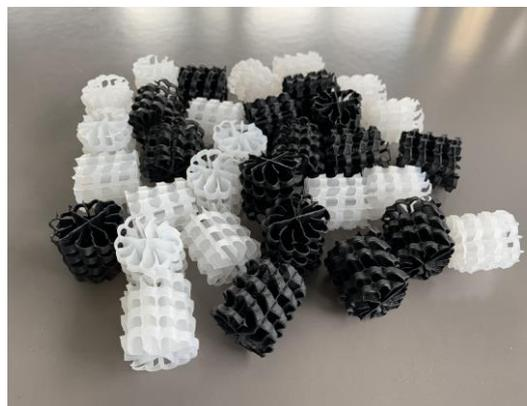
**Aufwuchskörper für die Versuche im Glasbecken. (Bild: Jana Trippel)**
