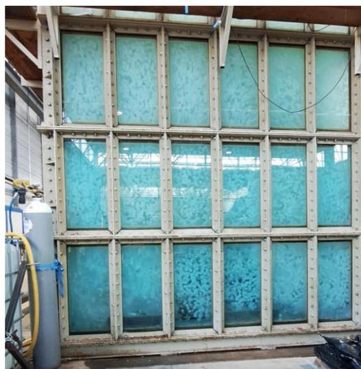
**Untersuchung des Einflusses von Aufwuchskörpern auf den Sauerstoffeintrag. (Bild: Jana Trippel)**
