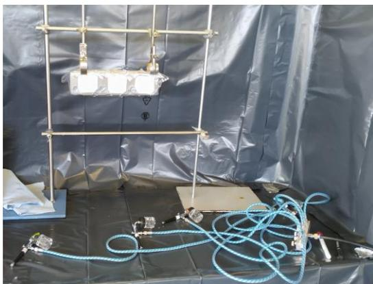
Spray coating Versuche zur Membranmodifikation via Layer-by Layer
