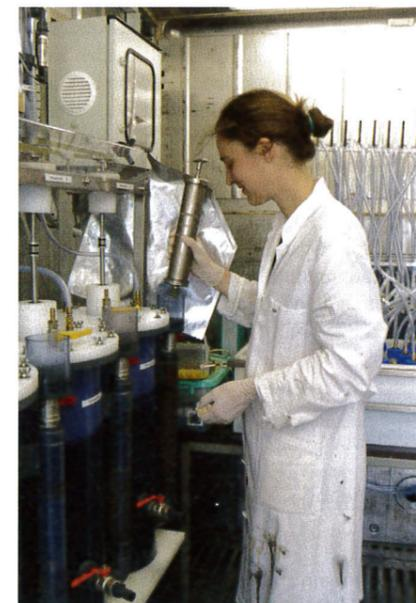
Bild 11 Versuchsreaktoren zur anaeroben Klärschlammstabilisierung
