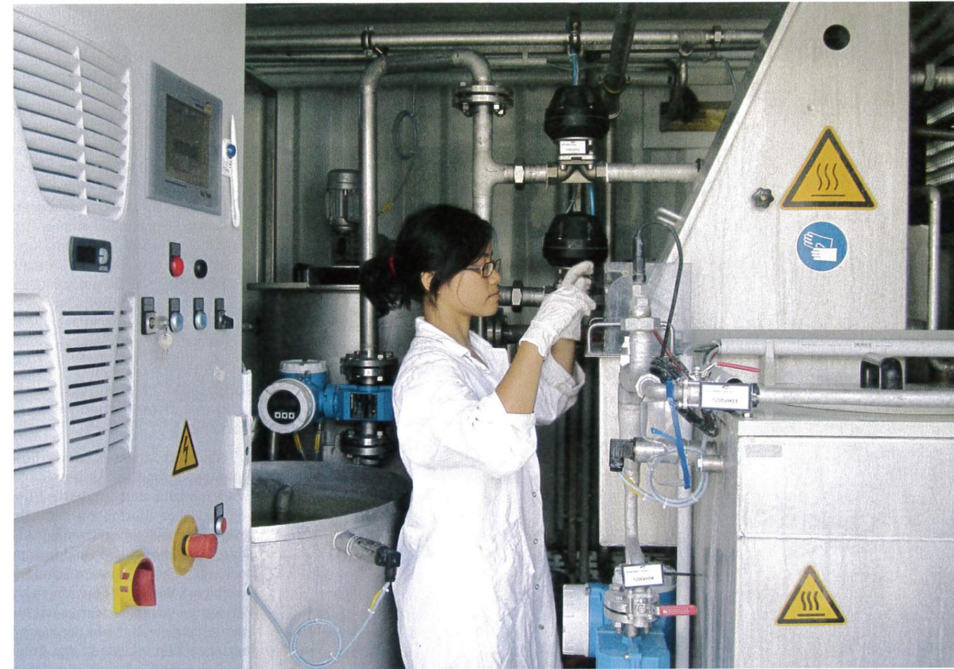
Bild 2 Membran-Pilotanlage zur Wertstoffrückgewinnung
