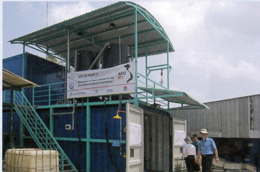
Bild 5 CP-Pilotanlage zur Abwasserentgiftung
