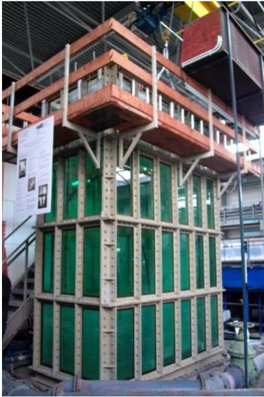
*Versuchsanlage: 17 m<sup>3</sup> Reinwassertank (Bild: IWAR)*
