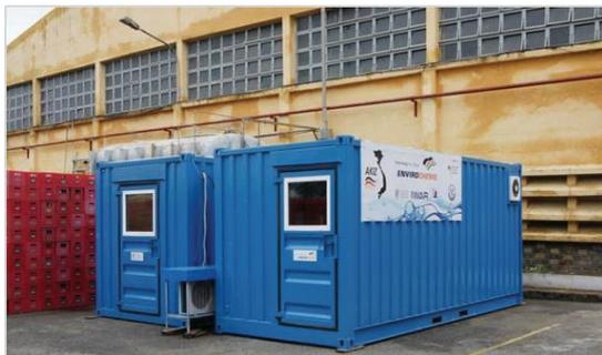
gen (Ultrafiltration und Nanofiltration). Sie bietet die Möglichkeit zur dezentralen Behandlung mit Filtration- und Fällungsverfahren.
